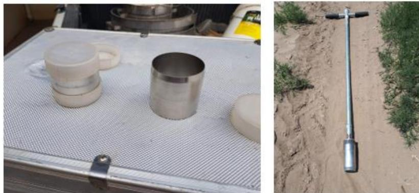
Figura 7. Barreno para determinar densidad aparente.
