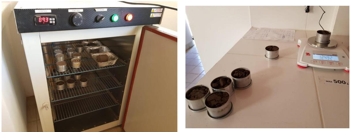
Figura 12. Horno para obtener datos de peso seco de muestras de suelo y muestras de suelo con balanza para obtener peso húmedo.
