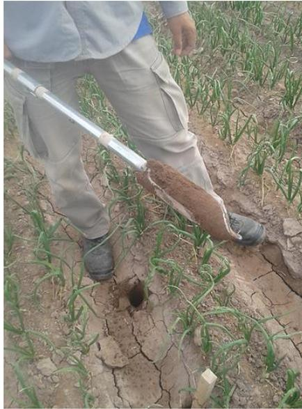
Figura 6. Barreno para muestra de humedad
